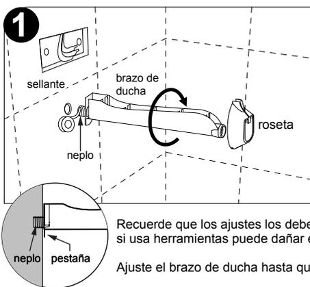
Recuerde que los ajustes los debe hacer usando únicamente su mano, si usa herramientas puede dañar el acabado del producto.
