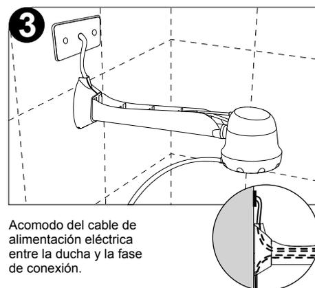
Acomodo del cable de alimentación eléctrica entre la ducha y la fase de conexión.
